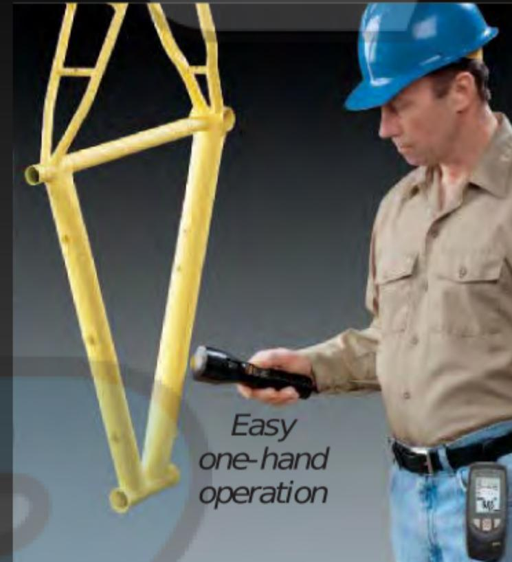
Medida confiable de recubrimientos en polvo no curados, utilizando tecnología ultrasónica sin contacto para calcular automáticamente y mostrar una predicción curada del espesor.
